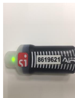
Рис.4 Периодически мигающий зеленый световой индикатор говорит о том, что ЧИП SIAC находится в активированном состоянии и готов к работе
